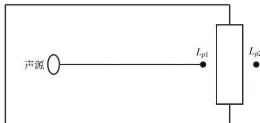
图 4-1 室内声源等效为室外声源图例
