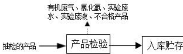
图3实验室检测工艺及产污环节图
